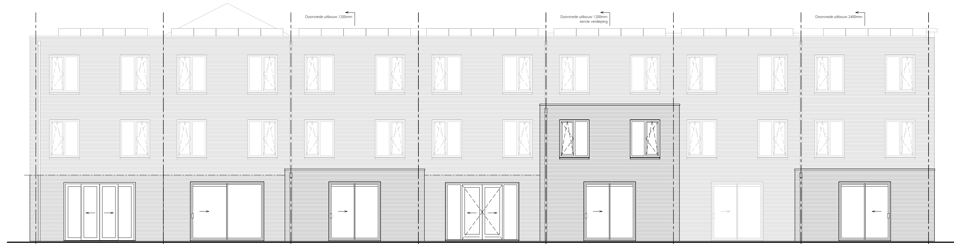
Achtergevel blok 1 1:100 1030100 vierdelige schuifpui 3200mm Optie mogelijk bij bwnr.: 72 t/m 85 1030400 schuifpui 3200mm Optie mogelijk bij bwnr.: 72 t/m 85 1010201 uitbouw 1200mm Optie mogelijk bij bwnr.: 72 t/m 85 1030200 openslaande deuren 3200mm Optie mogelijk bij bwnr.: 72 t/m 85 1010500 uitbouw 1200mm 1e Verdieping Optie mogelijk bij bwnr.: 72 t/m 85 1010401 uitbouw 2400mm Optie mogelijk bij bwnr.: 72 t/m 85
